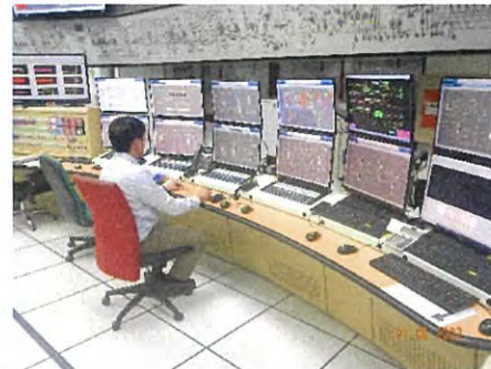
ภาพที่ 2-16 การตรวจสอบและควบคุมกระบวนการผลิตที่ CCR ด้วยระบบ DCS
